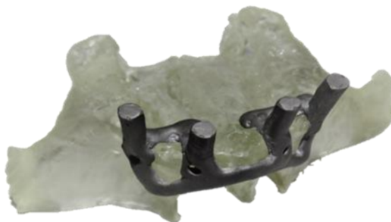
Рисунок 2. Вид отлитого имплантата на стереолитографической модели
